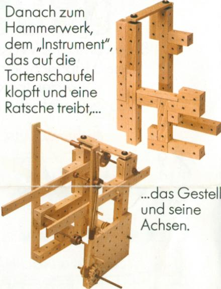
Danach zum Hammerwerk, dem „Instrument“, das auf die Tortenschaufel klopft und eine Ratsche treibt,...
