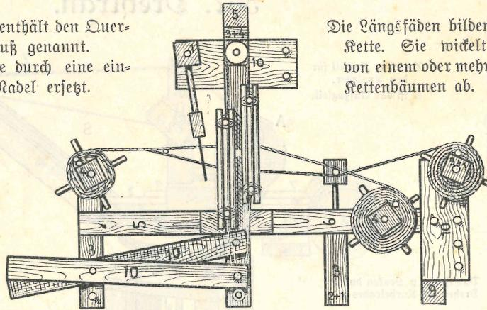
Die Längsfäden bilden die Kette. Sie wickelt sich von einem oder mehreren Kettenbäumen ab.
