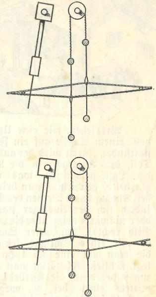
Die Lade schiebt den Schuß an das fertige Zeug.
