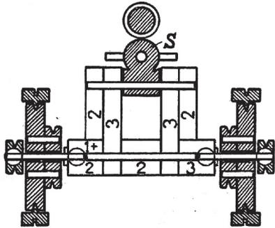
Abb. 1637/5. Die Lagerstellender Räder sind durch Zweiräder verbreitert.
